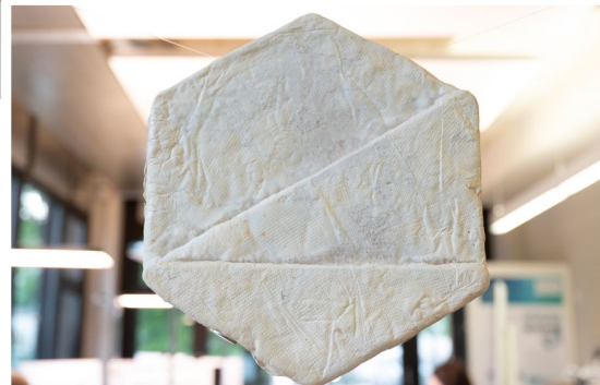
Ein Schallabsorber aus Pilzmyzel des Fraunhofer UMSICHT
