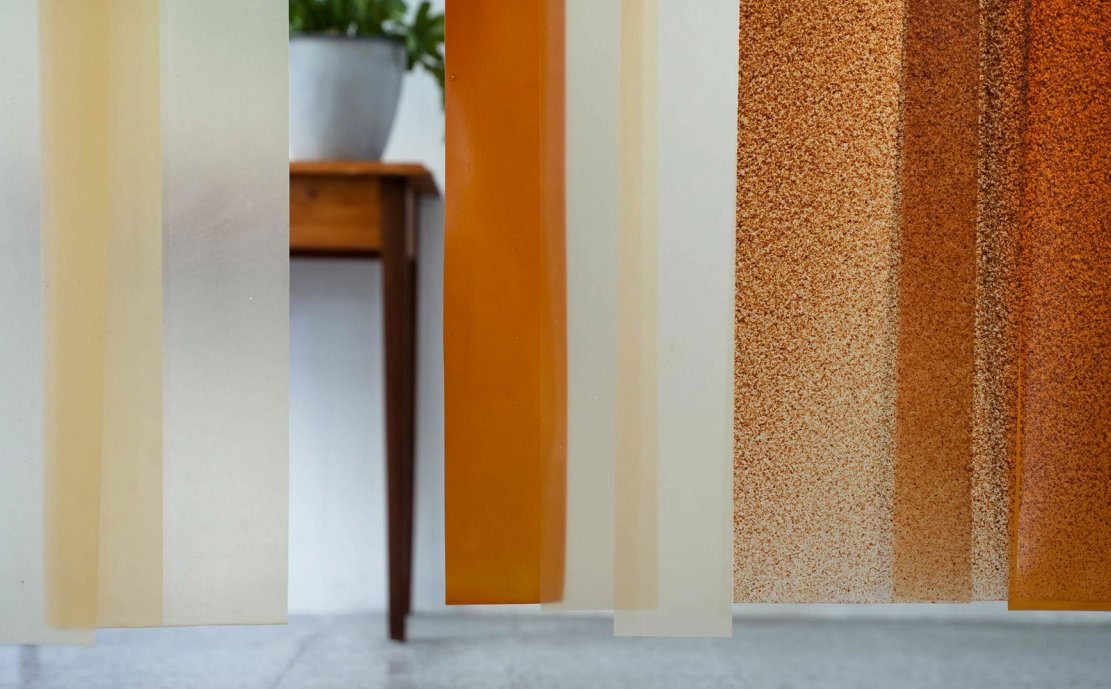
Hängende Trestерfolien als Raumteiler, hergestellt mit unterschiedlichen Körnungseinheiten des Apfelrestesters
