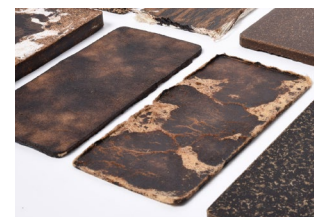
Stabile Plattenmaterialien auf Ligninbasis, kombiniert mit verschiedenen industriellen Reststoffen als Füllmaterial
