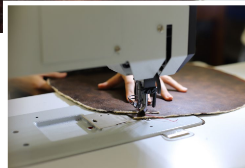
Das flexible, lederartige Material lässt sich an industriellen Ledernähmaschinen gut vernähen.
