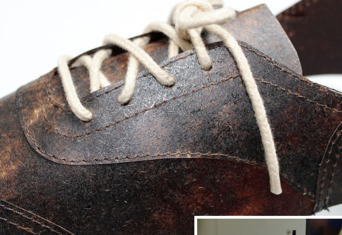
Prototyp eines Schuhs bestehend aus dem Material LignoLeather, einem flexiblen Material auf Ligninbasis in Kombination mit Holzfasern
