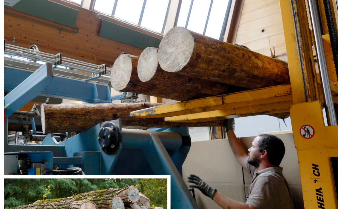
Der Baumstamm unterm Messer: Experimente zu Schäl furnieren aus der ersten Bastschicht
